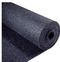
Die spezielle und strapazierfähige Bautenschutzmatte besteht aus einer PU-gebundenen, rezyklierten Gummigranulatmischung. Dort wo eine höhere mechanische Beanspruchung stattfindet oder eine erhöhte Reissfestigkeit verlangt wird, findet sie ihren Einsatz. Sie ist Zäh elastisch, hoch Druckbelastbar, Trittschall dämmend und weist eine hohe Schlag- und Reissfestigkeit auf. Ihren Einsatz findet sie im Hoch- und Tiefbau, auf dem Flachdach und auf Dachterrassen.
