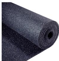
Unsere unverrottbare Trennlage VIP besteht aus einer PU-gebundenen, feinen rezyklierten Gummigranulatmischung, welche sich speziell für den Einsatz mit Vakuumdämmung eignet. Sie ist zäh-elastisch, hoch druckbelastbar und weist eine sehr gute Trittschalldämmung auf.
