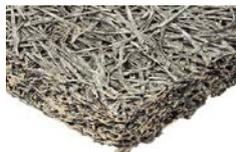
Heraklith C ist eine mit Grauzement gebundene Holzwolle-Leichtbauplatte für Innen- und Aussenanwendungen mit verschiedenen Eigenschaften wie z.B. Schallschutz. Hauptanwendung ist die Einlage in der Schalung beim Mitbetonieren. Sie dient auch als Putzträger für verschiedene Putzarten.
