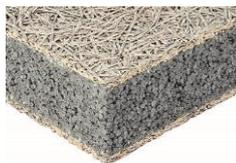
Der 3-Schicht-Aufbau von Heratekta C-3-032 besteht aus einem Kern aus expandiertem Polystyrol-Hartschaum und einer beidseitigen ca. 5mm starken, mit Grauzement gebundenen Holzwolle-Deckschicht. Die Platte zum Mitbetonieren dient hauptsächlich zur Wärmedämmung von Wänden, Decken, Säulen und zur Vermeidung von Wärmebrücken.
