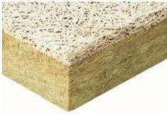
Die Mehrschicht-Dämmplatte besteht aus einem nicht brennbaren Steinwolle-Kern und einer einseitigen, mit Weisszement gebundenen Heraklith 2mm Holzwolle-Deckschicht.
