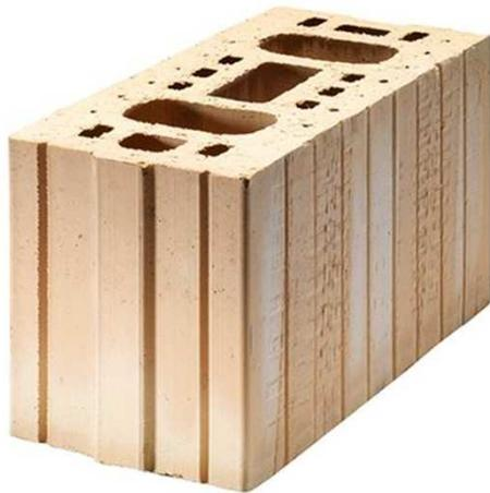
Backstein für Einsteinmauerwerk, mechanische Eigenschaften gemäss Deklaration, bewehrt (vgl. SIA-Norm 266). Orthogonal bewehrtes Mauerwerk mit horizontaler und vertikaler Bewehrung für grössere Zug- und Biegezugspannungen.
