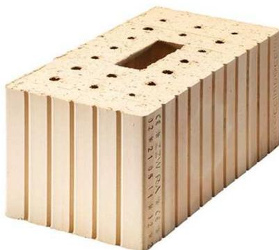
Backstein für Einsteinmauerwerk, mechanische Eigenschaften gemäss Deklaration, schalldämmend (vgl. SIA Norm 266). Der Backstein Calmo wird mit einem geringen Lochflächenanteil sowie mit einer erhöhten Trockenrohddichte produziert. Durch die erhöhte Masse können sowohl der Luftschall als auch der Körperschall wesentlich eingedämmt werden.
