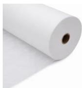
Trenn- und Schutzvlies Typ 2 (300g/m<sup>2</sup>) besitzt gute Zugfestigkeitseigenschaften. Es wird im Umkehrdachbereich als Filterschicht zwischen Kies und Vegetationsschicht (Intensivbegrünung) oder als Trennlage z.B. zwischen Splitt und armerter Betondruckverteilplatte (Fahrbahnplatte) bei Dächern mit Schwerverkehr eingesetzt.
