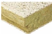
Die Dämmplatte besteht aus einem nicht brennbaren Steinwolle-Kern mit senkrecht zur Plattenoberfläche ausgerichteten Steinwollefasern. Dieser Kern ist beidseitig mit einer aus Weisszement gebundenen und nicht brennbaren Heraklith Holzwolle-Deckschicht beplankt.
