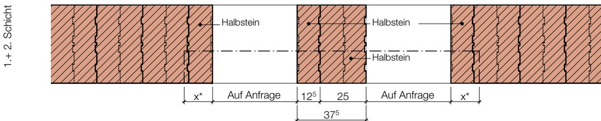
$x^*$  Auflager bei Vordersturz min. 11<sup>5</sup> cm; bei Sturzbrett min. 15 cm
