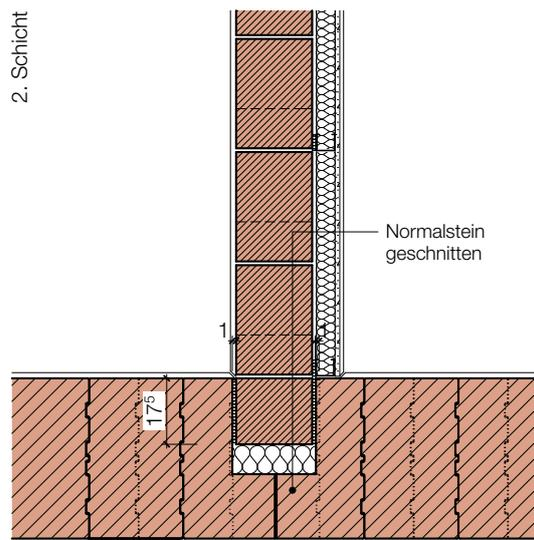
Zuerst eine Seite vormauern, danach das Wandlager versetzen; im Anschluss die andere Seite hochmauern.
